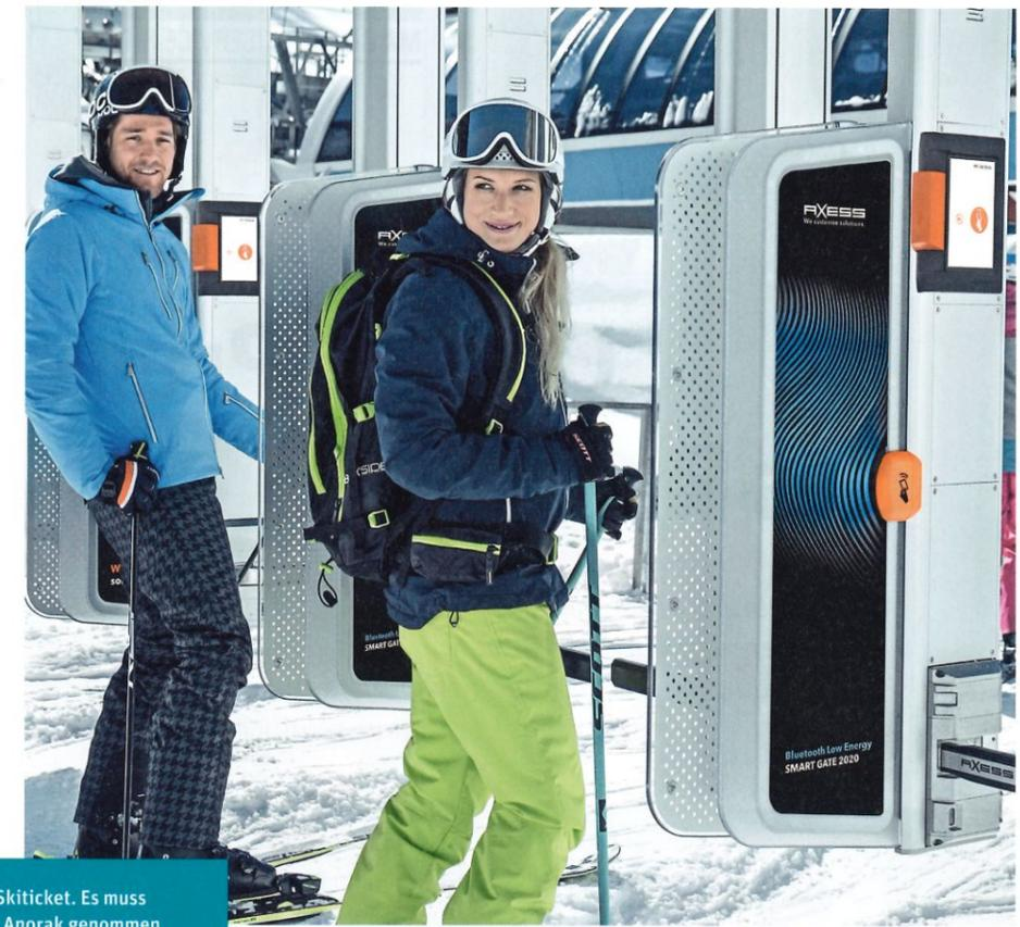
Das Handy wird zum Skiticket. Es muss nicht einmal aus dem Anorak genommen werden, sondern kommuniziert selbständig mit dem Gate wie ein RFID-Ticket.
